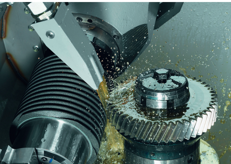
Wälz- und Profilschleifmaschine der LCS-Baureihe von Liebherr-
